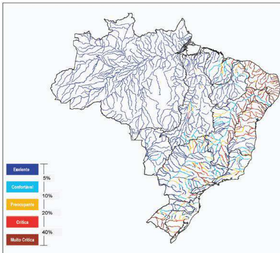
Figura 5- Relação entre a demanda e a disponibilidade hídrica nos principais rios brasileiros
