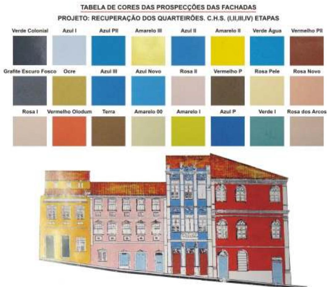
**Figura 28.** A Tabela de cores das prospecções das fachadas determina as cores a serem usadas na pintura das fachadas dos imóveis recuperados. (Governo do Estado da Bahia, IPAC, Conder, 1995, p. 88, 89)
