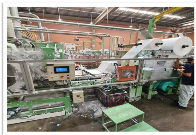
Figura 31 – Fabricação do tapete higiênico (PET).
