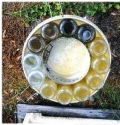
Figura 36: Amostragem de qualidade da água pluvial. Início da precipitação apresenta água de tom marrom escuro e após 45 minutos já a mostra o recipiente com água translúcida
