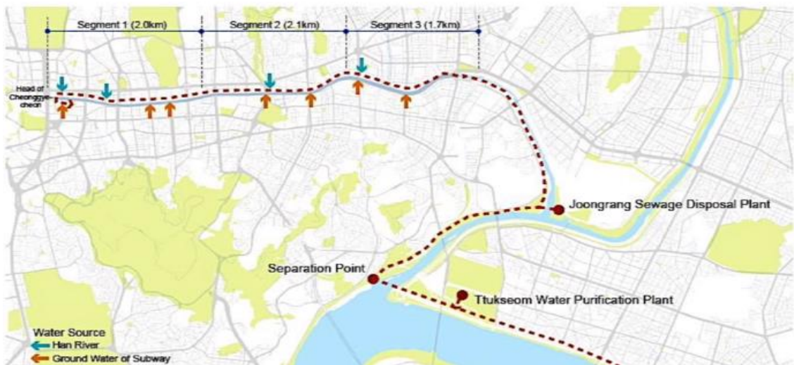
Figura 44: Esquema especializado no fornecimento de água do Rio Han para Cheong Gye
