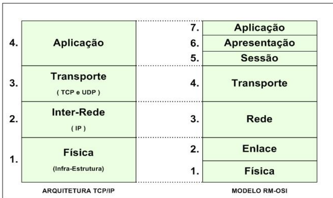
Figura 10. Modelo RM-OSI e Arquitetura TCP/IP
