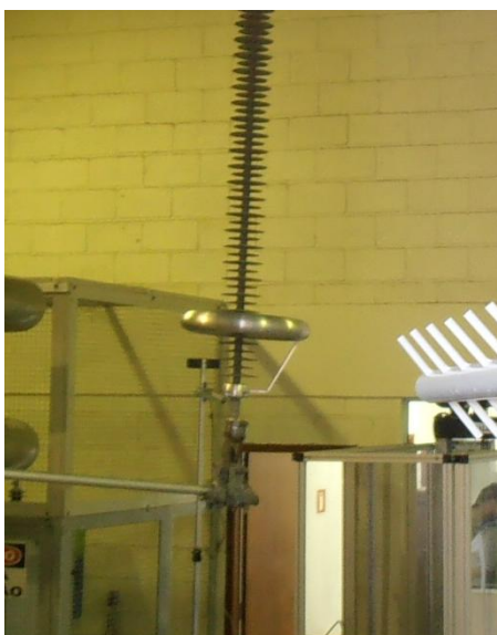
Figura 87. Isolador no experimento, com anel anti-corona de diâmetro do condutor de 7,0 cm
