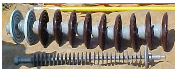
Figura 23. Comparativo entre isoladores da classe de tensão de 138 kV (MANARA, 2012).
