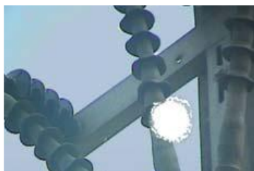
Figura 21. Efeito Corona em uma mufla visualizado através da câmara DayCor® (DAYCOR®, 2008)
