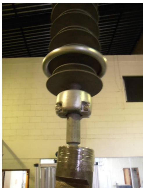
Figura 86. Isolador no experimento, com anel anti-corona de diâmetro do condutor de 1,5 cm
