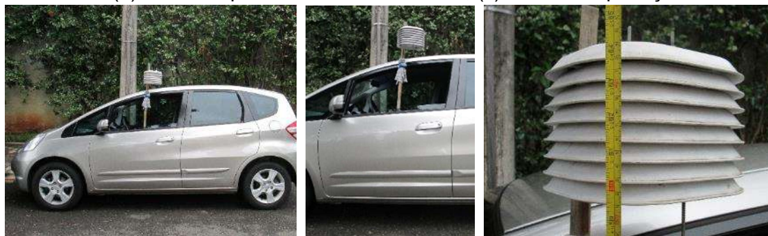
Figura 22 – Fotografias do conjunto instalado. (a) automóvel com o conjunto instalado; (b) haste acoplada na lateral do veículo; (c) detalhe da proteção.
