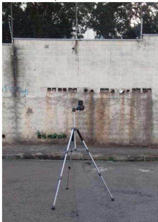
Figura 18 – Fotografia do conjunto para levantamento do Fator de Visão do Céu – Tripé, câmera e lente olho de peixe.
