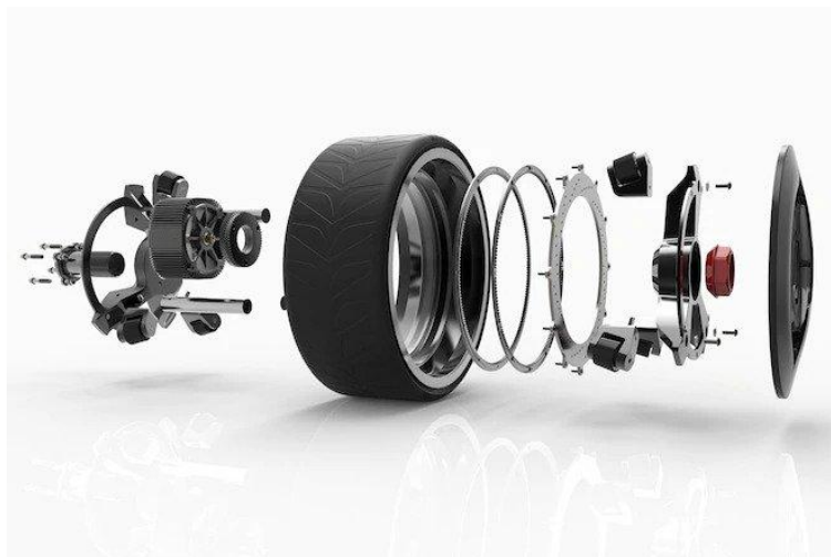
Figura 68 - Perspectiva explodida da roda com motor
