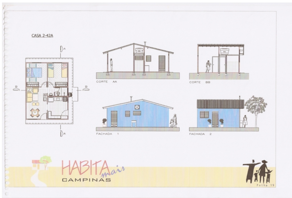
Figura 12– Tipologia de Casa 2-42 utilizada na construção de novas moradias durante a Regularização Fundiária. Fonte: SEHAB, 2006
