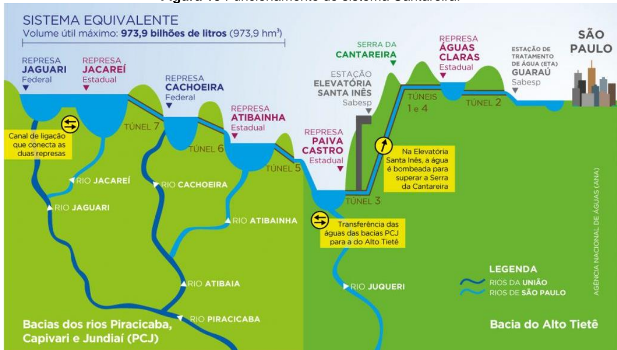
Figura 15 Funcionamento do sistema Cantareira.
