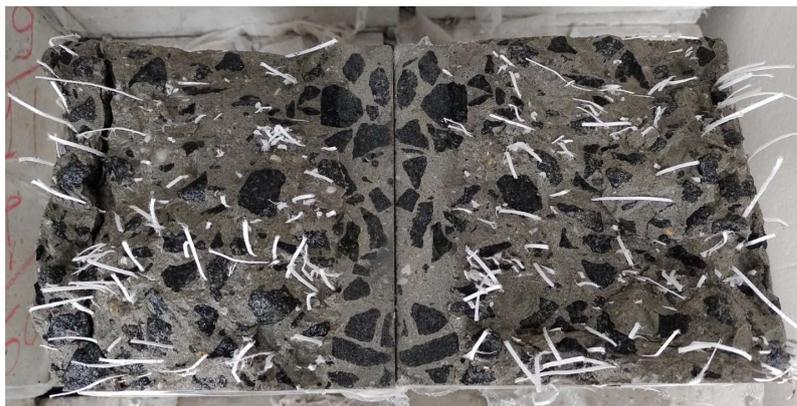
Ao comparar as duas figuras, observa-se que a distribuição de fibras ao longo da seção do CP04 se deu de maneira heterogênea, com mais espaços vazios em relação à seção do CP02. Também se nota maior quantidade de fibras na seção do CP02, que em conjunto com a melhor distribuição, apresentou melhores resultados de resistência.
