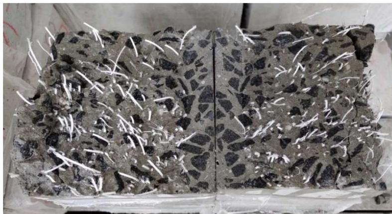
**Figura 43.** Seção transversal CP02 Concreto<sub>GFRP</sub>
