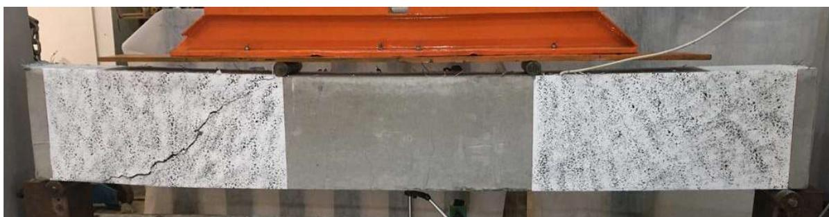
As Figuras 54 e 55 apresentam o modo de ruptura das vigas GFRP-CF-CE e BFRP-CF-CE, respectivamente. Ambas as vigas apresentaram ruptura à flexão por esmagamento do concreto. Esse resultado mostra que a substituição de parte dos
