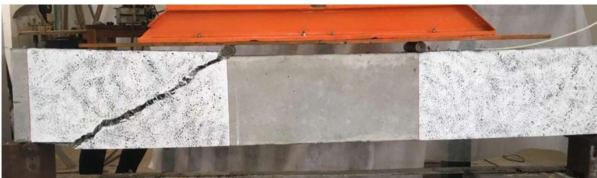
**Figura 53.** Modo de ruptura da viga BFRP-CF-SE.
