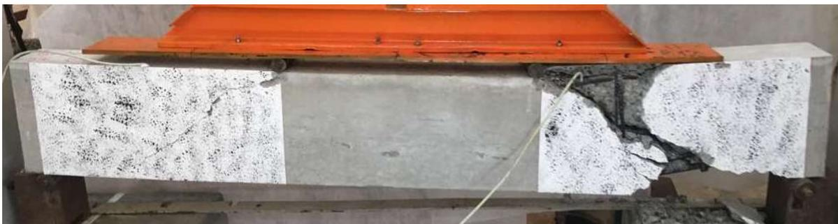
**Figura 49.** Ruptura do estribo.
