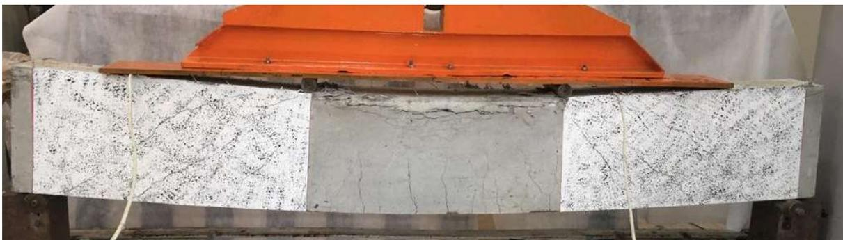
**Figura 55.** Modo de ruptura da viga BFRP-CF-CE.
