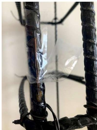
A Figura 35 apresenta os extensômetros já conectados ao cabo manga de seis vias e prontos para serem utilizados.
