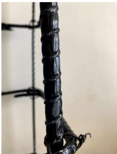
**Figura 34.** Extensômetro fixado na barra.
