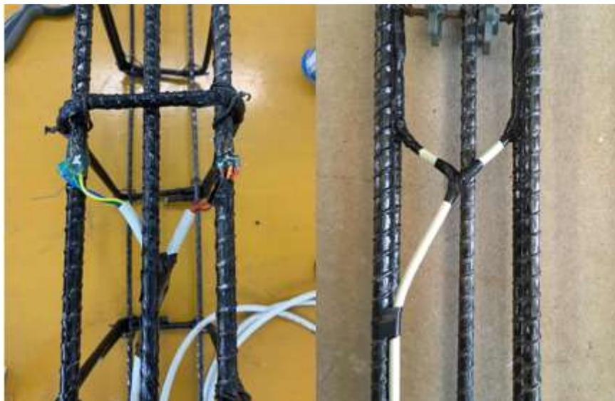
Os extensômetros foram posicionados nas armaduras longitudinais para medições das deformações utilizando-se o sistema de aquisição de dados Quantum X (DAQ), da HBM (Figura 36). A leitura dos resultados obtidos dos extensômetros e do transdutor de deslocamento foi feita por meio do programa CatmanEasy.
