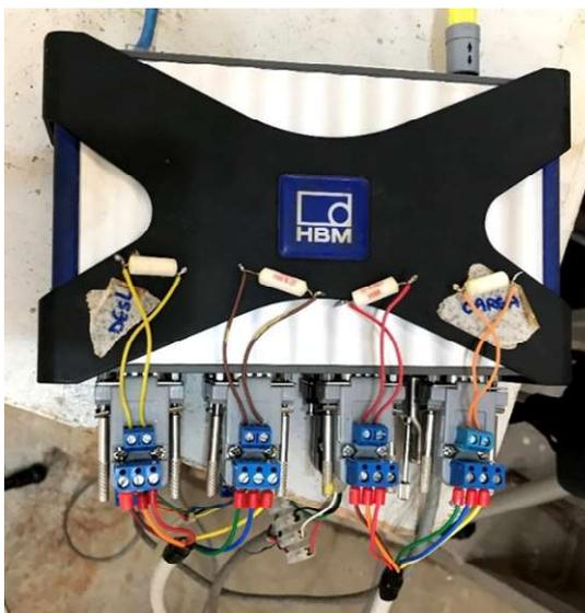
Os ensaios foram realizados em um pórtico com capacidade de carga de 50 toneladas, situado no Laboratório de Materiais da PUC-Campinas. O transdutor de deslocamento utilizado para medição da flecha é do modelo WA-50mm-T, da HBM. O
