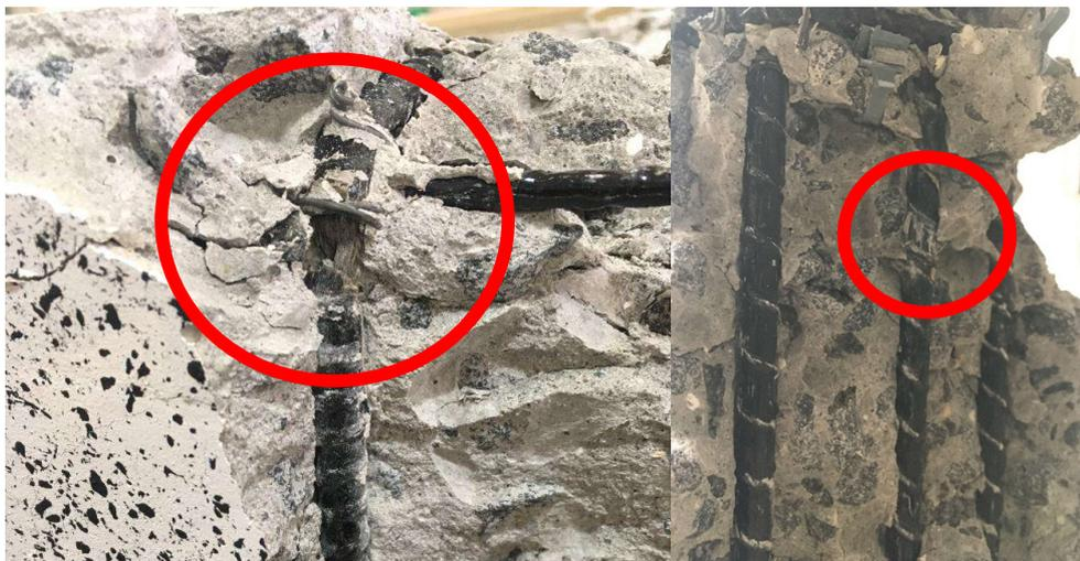
As Figuras 52 e 53 apresentam a deformação das vigas GFRP-CF-SE e BFRP-CF-SE, respectivamente. Ambas as vigas apresentaram ruptura por cisalhamento, indicando que a substituição total dos estribos por macrofibras de polipropileno não foi suficiente para alterar o modo de ruptura frágil da estrutura por cisalhamento.
