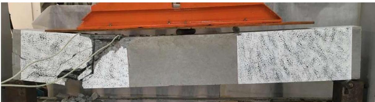
**Figura 51.** Ruptura do estribo.
