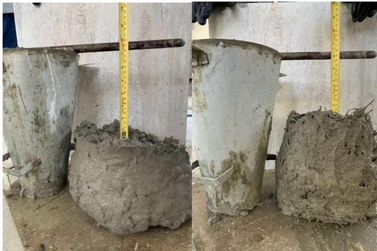
**Figura 41.** Resultado do ensaio de consistência para os concretos Concreto<sub>BFRP-SF</sub> e Concreto<sub>BFRP-CF</sub>.
