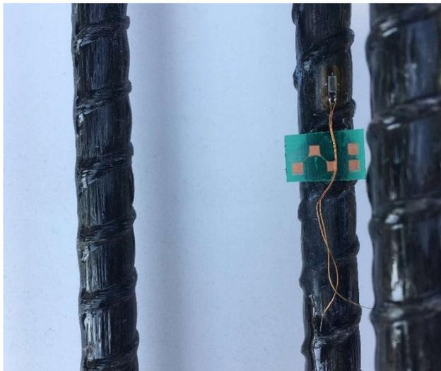
Para a fixação dos extensômetros, inicialmente foi necessário lixar a região de contato, para retirar a resina. Após lixada, a região de contato foi higienizada com álcool e posteriormente o extensômetro foi fixado com supercola, como pode ser observado nas Figuras 33 e 34.
