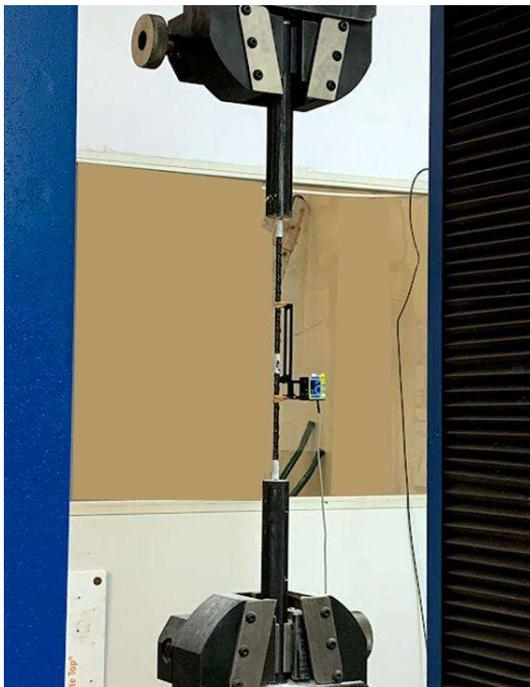
Por meio do ensaio obtiveram-se os valores de resistência à tração, deslocamento e módulo de elasticidade da barra. O ensaio é validado quando a barra apresentar ruptura no comprimento livre, que diz respeito à posição fora da região de ancoragem, tal como apresentado na Figura 27.
