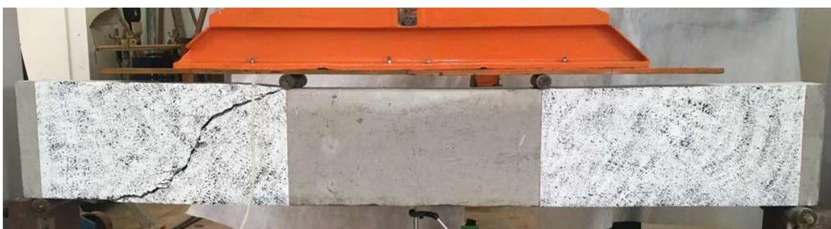
A Figura 48 exibe a deformação da viga GFRP-SF-CE, que apresentou ruptura por força cortante-tração com a ruptura do estribo, conforme mostra a Figura 49.
