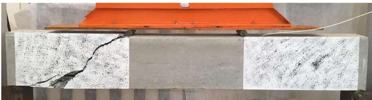
**Figura 47.** Modo de ruptura da viga BFRP-SF-SE.
