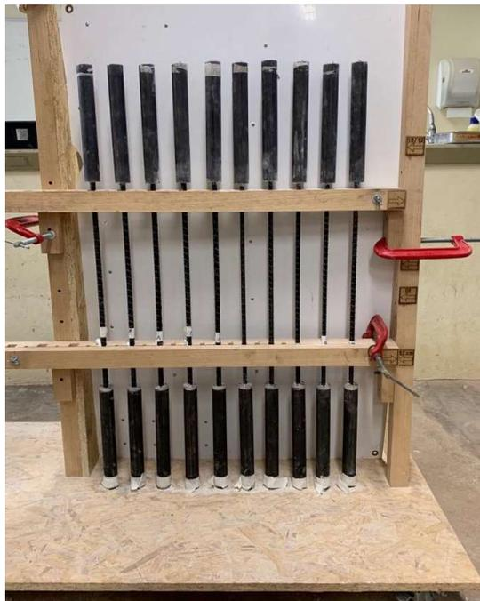
Durante a moldagem, a argamassa expansiva se encontrava no estado líquido, e foi necessário empregar tampas na parte inferior dos tubos para evitar seu vazamento. Na parte superior, a tampa teve a função de manter a barra alinhada no interior do tubo.
