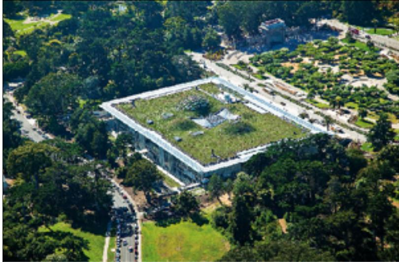
Fonte: <[www.arcoweb.com.br](http://www.arcoweb.com.br)> data de acesso 31/07/2019. Do arquiteto Renzo Piano, a obra conta o uso de material reutilizado e reciclado em 90%, um sistema de recuperação de calor, vidros de alta eficiência combinado com aberturas de controle de temperatura, além de claraboias com uso de luz natural. As ondulações do telhado permitem melhor ventilação, e o teto verde auxilia no controle da temperatura interna.
