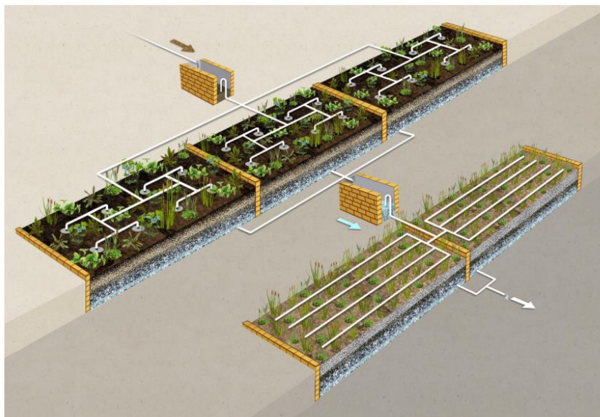
Figura 19 – Ilustração esquemática da estrutura de um jardim filtrante francês tradicional. Fonte: Sezerino; Pelissari, 2021.
