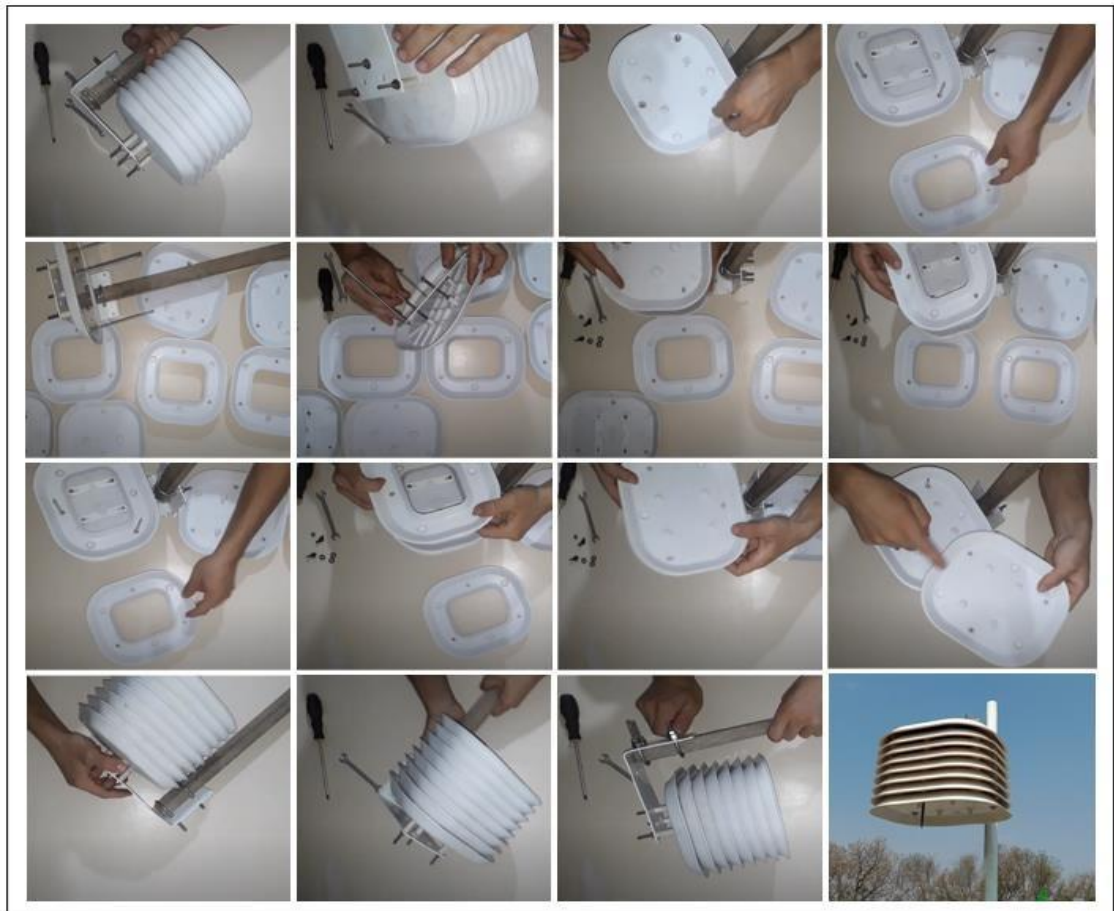
Figura 6 –Desmontagem do abrigo para colocação do sensor e remontagem para utilização do equipamento.
