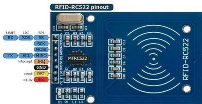
Figura 5 - Módulo RFID MFRC522
